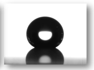
Angles de contact  $H_2O > 150^\circ$ , AC huile  $> 140^\circ$ Énergie de Surface  $\gamma = 1$  mN/m (téflon  $\gamma = 15-20$ mN/m)
