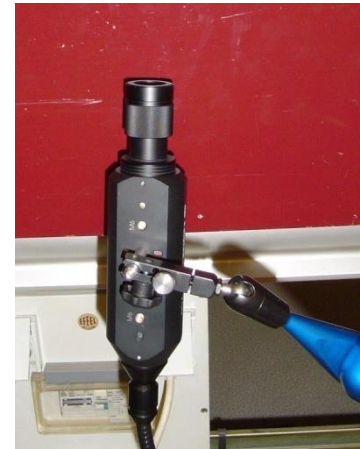
Montage ayant servi à la caractérisation vibratoire d'un dispositif médical
